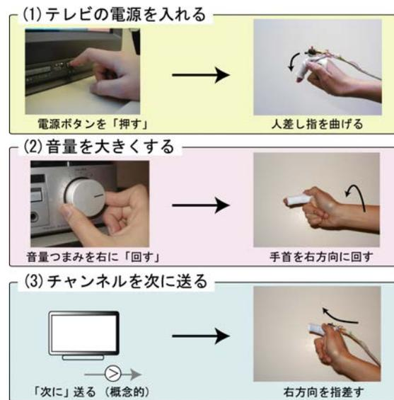
図 9: テレビ操作とジェスチャの対応付け (抜粋)
