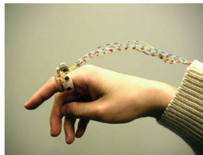
図 5: Ubi-Finger プロトタイプ Ver.3 装着例
