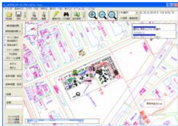
図6 ICタグ位置情報とGISとの統合例
