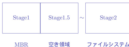
図 1: 従来の GRUB の典型的な物理的構造
